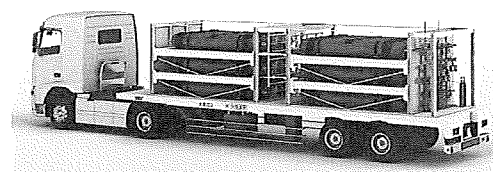
45MPa圧縮水素運送自動車 (トレーラー) のCGイメージ
